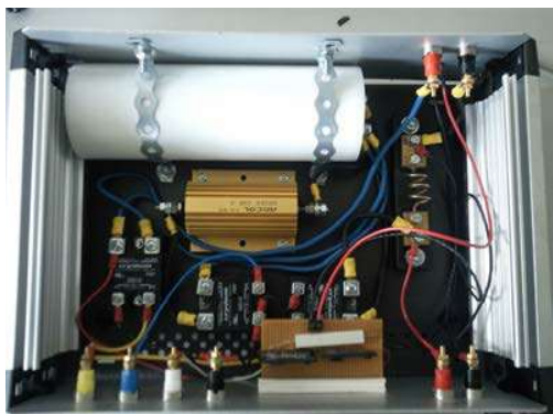
Figura 9. Sistema trazador de curvas I-V basado en carga capacitiva e instalac en la Universidad de Jaén.
