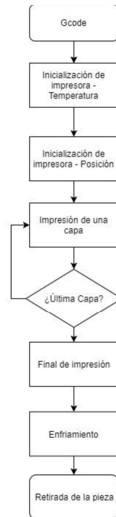
Figura 5. Diagrama de flujo básico sobre el funcionamiento general de una impresora.
