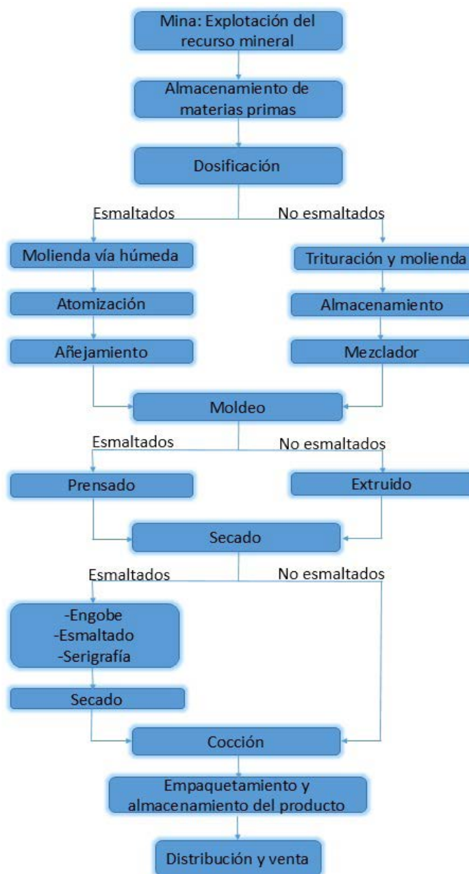
Figura 2. Flujograma de los procesos industriales para la elaboración de productos esmaltados y no esmaltados.
