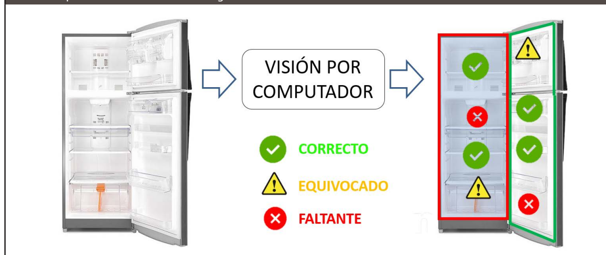
Figura 1. Ilustración del reto en la construcción de un sistema de visión por computador para la identificación de accesorios faltantes/equivocados en unidades de refrigeración.
