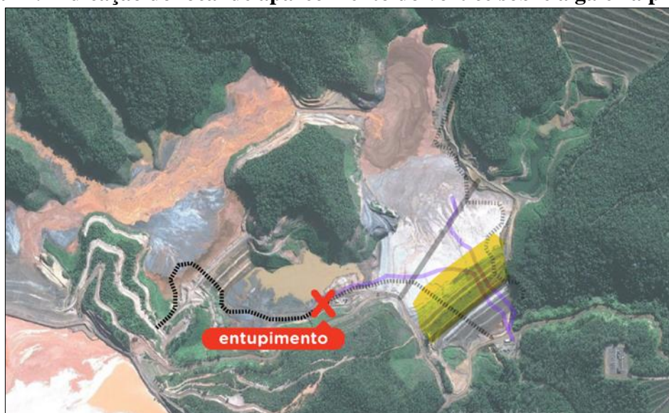
Figura 12: Indicação do local de aparecimento do vórtice sobre a galeria principal.
