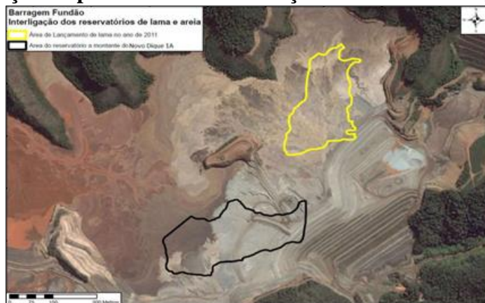
Figura 16: Projeção do perímetro de acumulação da lama sobre rejeito arenoso.
