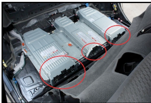
Figura 8. Proceso de extracción de la batería (Hybrid Automotive, 2016)
