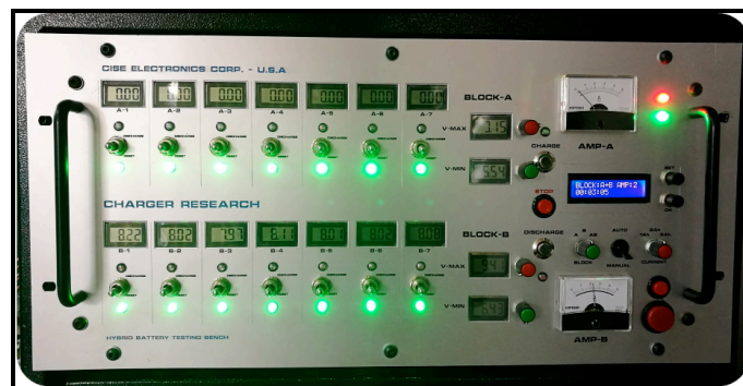
Figura 6. Panel de control del Banco de Pruebas para baterías híbridas (TAAET Electronics , 2017)
