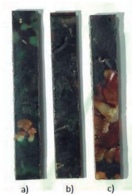
Figura 7. Muestras de las mezclas de PET: a) PA-PV, b) PA-PV-PT, c) PA-PT. Fuente: Los autores.
