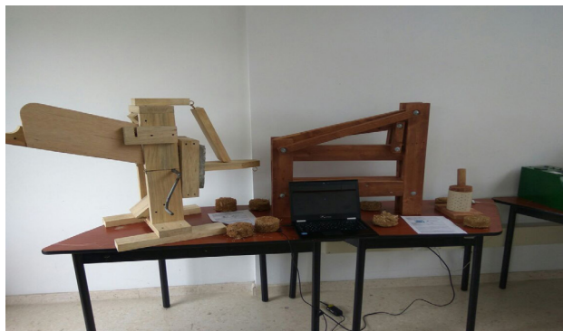
Figura 8. Modelo de Prensa para conformación de las briquetas, para estufa eco-eficiente. Fuente: Elaborado por Grupo de Investigación Fórmula ECOSENNOVA Chía-Cundinamarca
