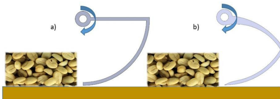
Figura 5. a) Uña máximo volumen y b) uña optimizada entre volumen homogeneidad. Fuente: Los autores.
