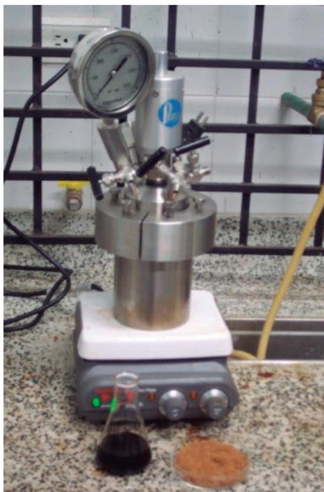
**Figura 1.** Reactor para la realización de la hidrólisis básica, licor negro y aserrín después de la hidrólisis.
