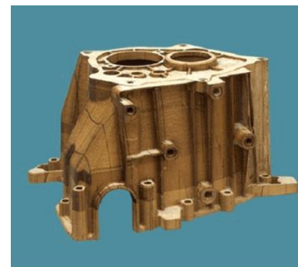
Fig. 5. Pieza fabricada mediante la técnica LOM
