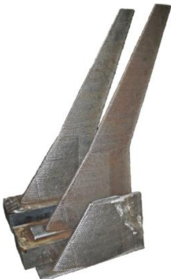
Fig. 3 Pieza de acero fabricada mediante tecnología WAAW
