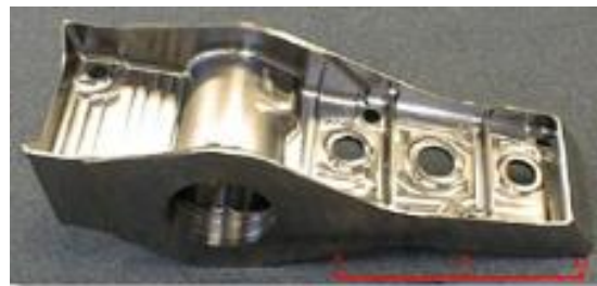
Fig. 6 Pieza fabricada con tecnología LAM
