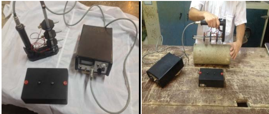
Figura 2.- Equipo Wenner de 4 puntas, el patrón y el procesador. 4 lecturas por probeta.
