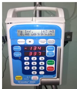
Figura 2. Bomba volumétrica (Graseby 3000) utilizada para la perfusión continua de los fármacos anestésicos
