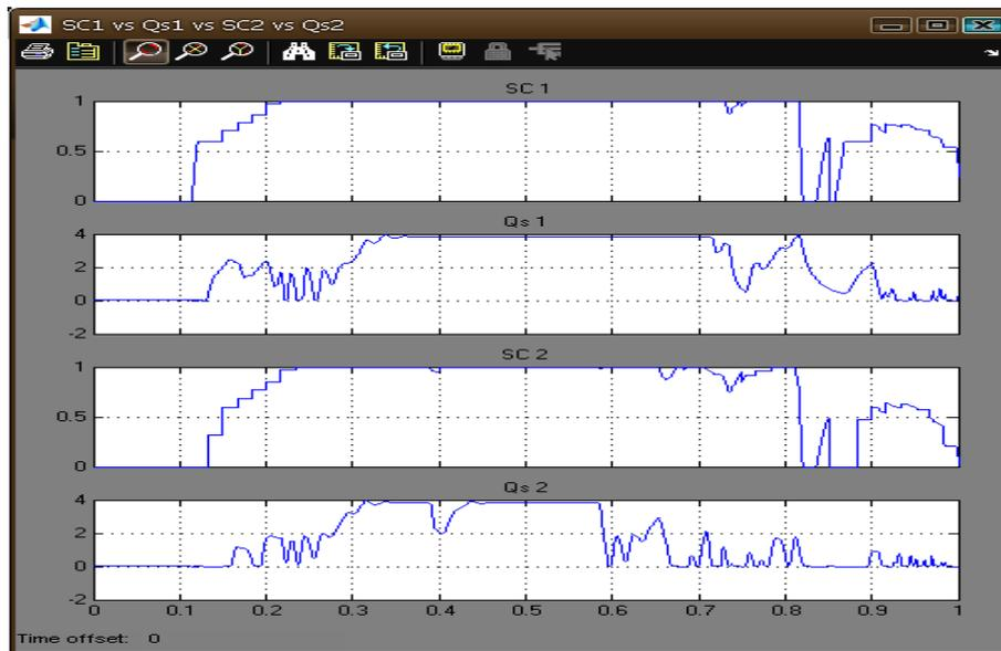
Figura 9. Flujos de Salida de las Bombas 1 y 2 con las respectivas salidas del controlador para el mismo caso de la figura 8.
