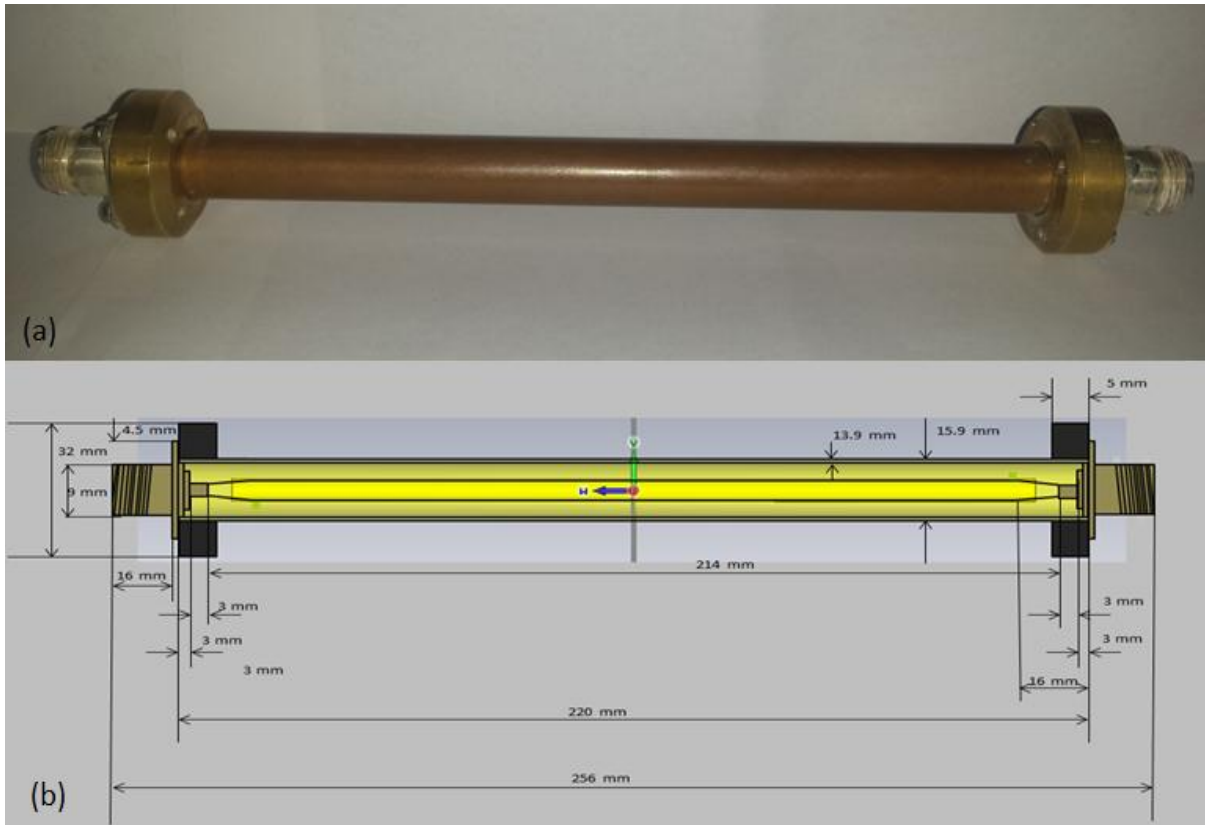
Figura 1 Línea de transmisión coaxial construida.
