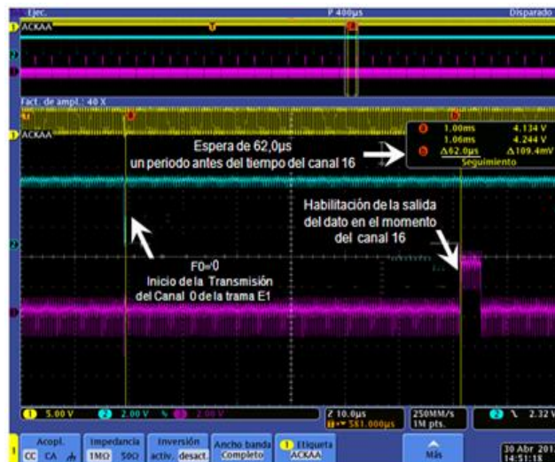
Fig.9 Implementación del Subsistema de Temporización.
