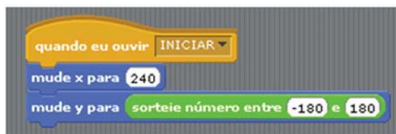
Figura 9-Script responsável pelo posicionamento aleatório do alvo (movimento vertical).
