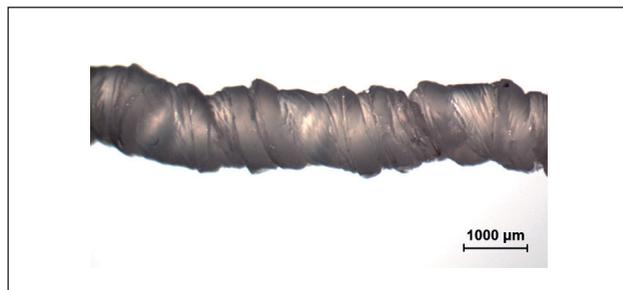
**Figura 8.** Fractura del fundido de una hebra de 1 mm de diámetro.
