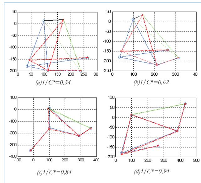
Figura 3. Análisis de sensibilidad en la posición 100, 0 para tres mecanismos sintetizados.
