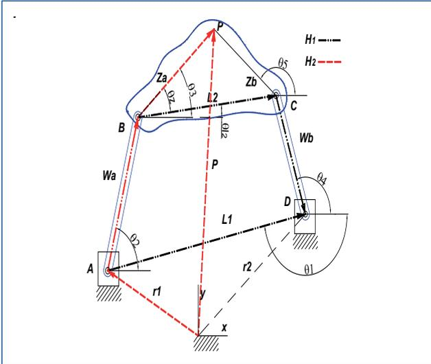
**Figura 1.** Ciclos para análisis de sensibilidad en un mecanismo de cuatro barras sintetizado analíticamente
