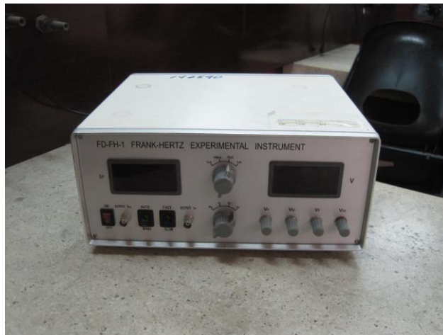
Figura 4. Equipo experimento de Franck y Hertz
