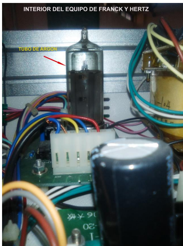
Figura 6. Vista interior del equipo experimento de Franck y Hertz mostrando el pentodo con Argón
