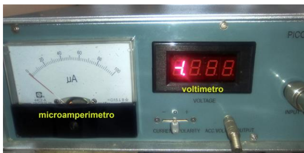
Figura 3. Frente de equipo efecto fotoeléctrico, mostrando los instrumentos de medición
