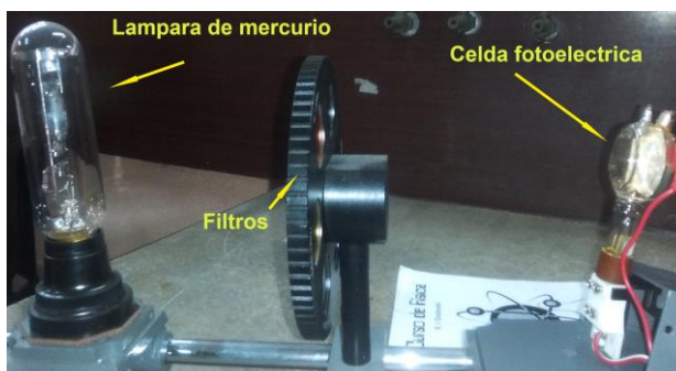
Figura 2. Banco óptico efecto fotoeléctrico mostrando su interior
