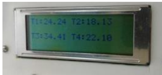
Figura 12. HMI unidad maestra de recolección de datos Fuente: Elaboración propia (2017)
