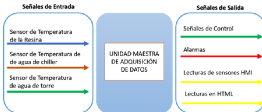
Figura 3. Diagrama de entradas y salidas
