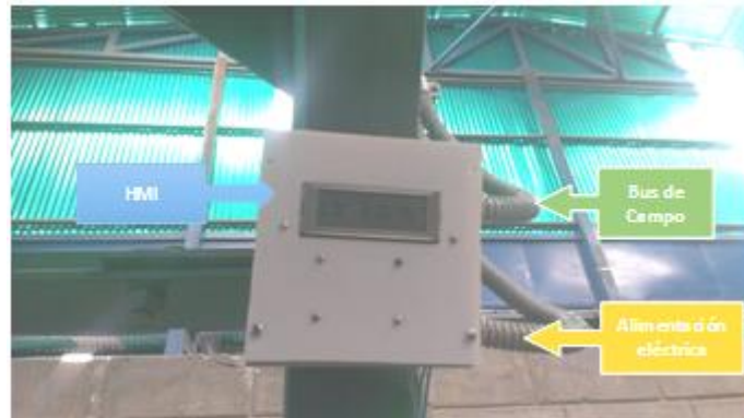
Figura 11. Unidad maestra de Recolección de Datos con HMI Fuente: Elaboración propia (2017)
