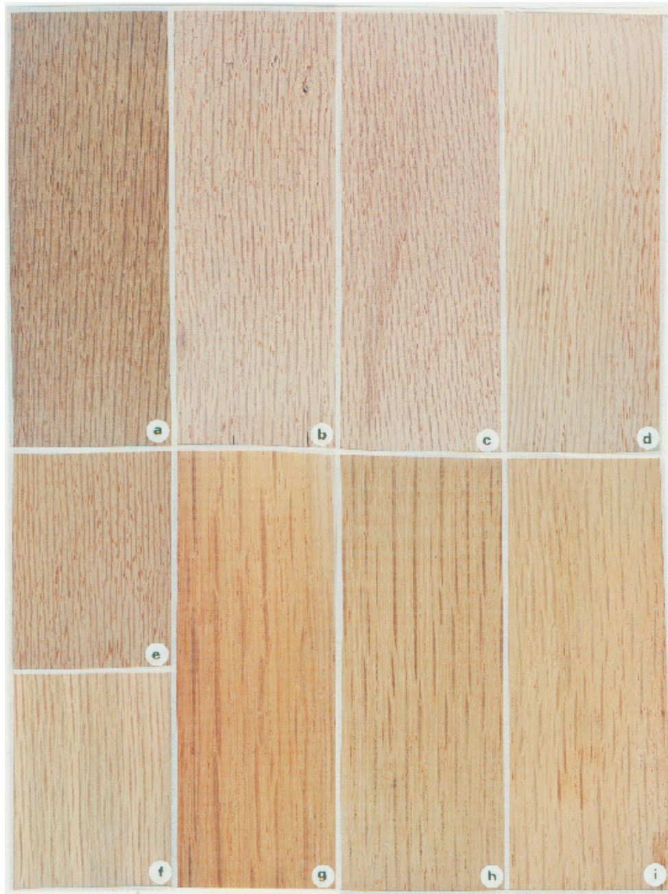
Lám. 1. Tablillas tangenciales. a. Quercus candicans . b. Q. Cocolobifolia . c. Q. Crassifolia . d. Q. Durifolia . e-f. Q. Sideroxylo (encinos rojos). g. Q. Convallata . h. Q. laeta . i. Q. Potosina (encinos blancos).
