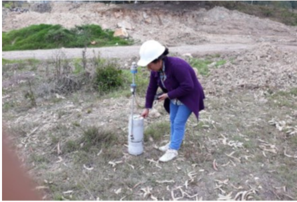
Figura 2. Monitoreo de Material Particulado 2.5
