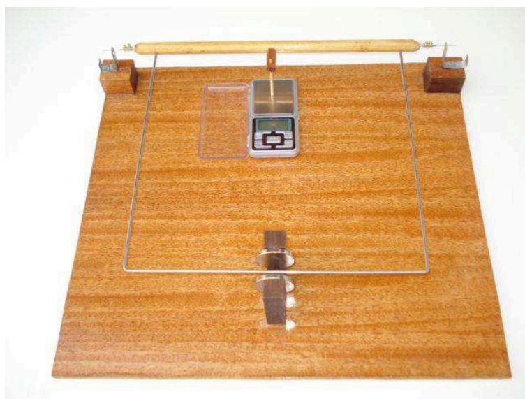
Fig. 3 – Versão final do aparato. Uma espira em forma de U fica sujeita à força magnética na parte do fio reto e longo numa extremidade da espira. A outra extremidade é articulada em um eixo de madeira, de forma que o torque gerado pela componente vertical da força magnética pode ser medido diretamente em uma mini balança eletrônica.
