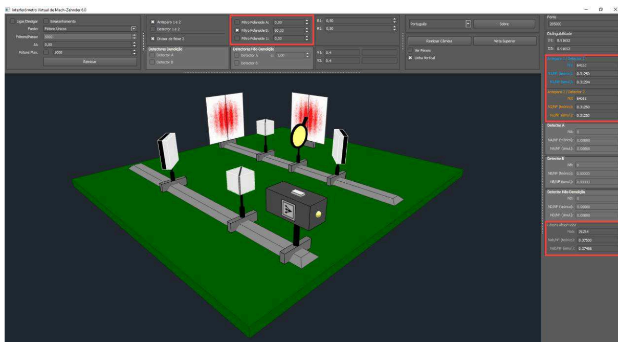
Fig. 12 – Absorção de fótons pelo polaroide inserido no braço B do interferômetro e a formação de padrões de interferência com menor visibilidade.
