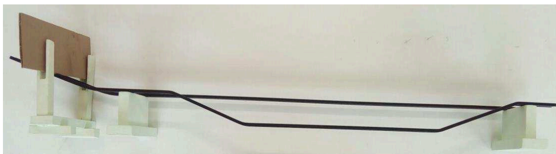
Fig. 10 – Vista lateral dos trilhos 1 e 2 fixados com parafusos nas bases de madeira.
