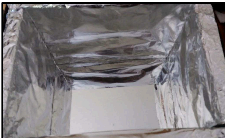
Fig. 3 – Acabamento em papel alumínio feito no forno solar construído pelo grupo G5 . Fonte: Grupo G5 .
