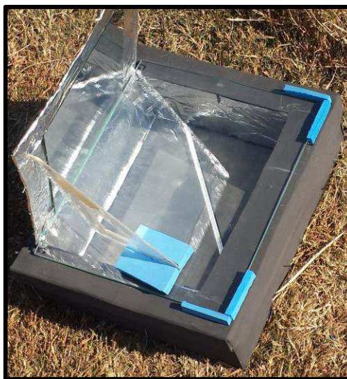
Fig. 4 – Forno solar construído pelo grupo G4 , com fechamento superior em vidro. Fonte: Grupo G4 .
