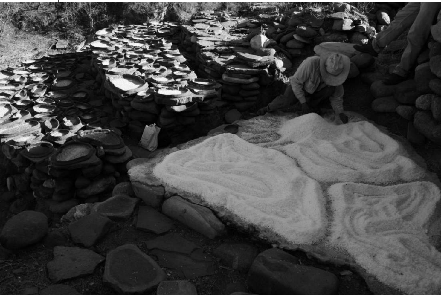
Figura 5. Secado de sal obtenida por evaporación en pequeños cuencos, Tejupilco, Estado de México, 2009 (Foto: B. Castellón). Figure 5. Drying of salt obtained by evaporation in small bowls, Tejupilco, State of Mexico, 2009 (photo: B. Castellón).
