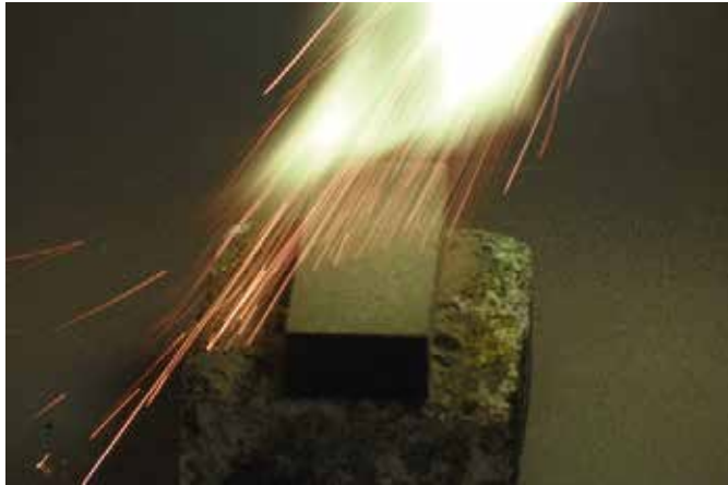
Figura 5. Depósito de recubrimientos de alúmina a través del proceso de rociado térmico por llama Fuente: Autores del trabajo
