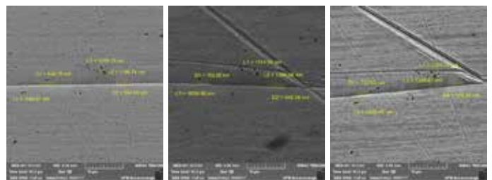
Figura 8. Dimensiones de las huellas presentes en el espécimen de acero AISI 304 sometido a desgaste erosivo por cavitación para tiempos de a) 240 min, b) 960 min y c) 1440 min Fuente: Autores del trabajo
