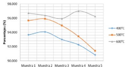
Figura 4. Porcentaje de disminución del peso en función de la temperatura de incineración.
