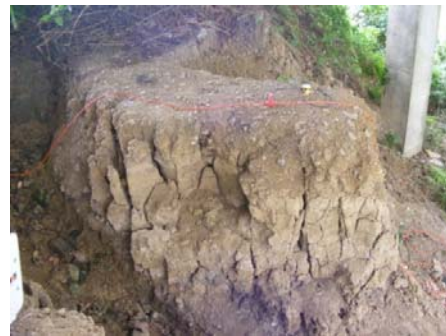
Figura 5. Grietas por desecación en el talud del cauce del río, formado por suelos arcillosos expansivos.
