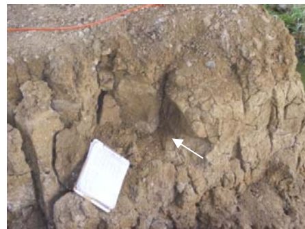
Figura 6. a) Grieta en corona del talud, evidenciando la existencia de pequeños deslizamientos. b) Desprendimiento del material arcilloso. Destrucción parcial del talud.
