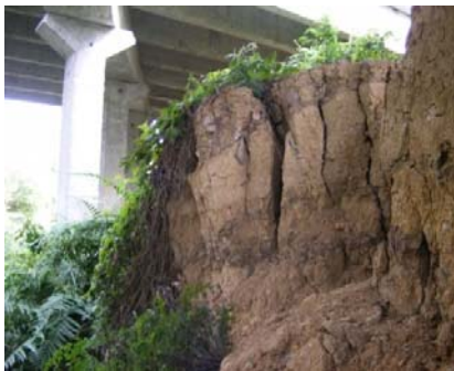
Figura 5. Grietas por desecación en el talud del cauce del río, formado por suelos arcillosos expansivos.
