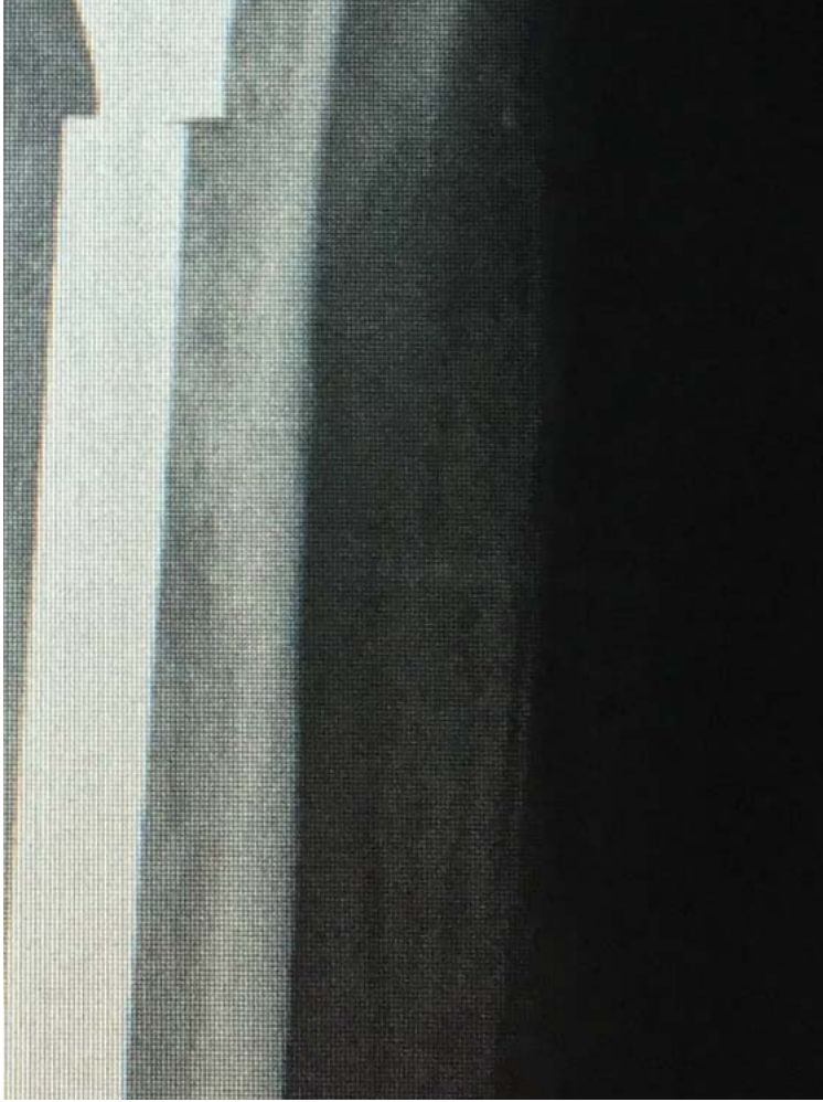
Fig. 1. Rotura vástago femoral de PTC no cementada. Tipo Furlong. A): Radiografía simple de pelvis. Proyección anteroposterior. B) Imagen del implante extraído.
