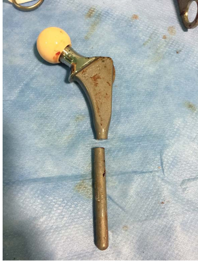
Fig. 1. Rotura vástago femoral de PTC no cementada. Tipo Furlong. A): Radiografía simple de pelvis. Proyección anteroposterior. B) Imagen del implante extraído.
