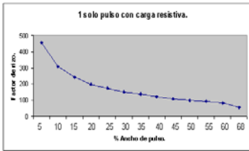
Figura 6.- Factor de rizo con control PWM, un solo pulso.
