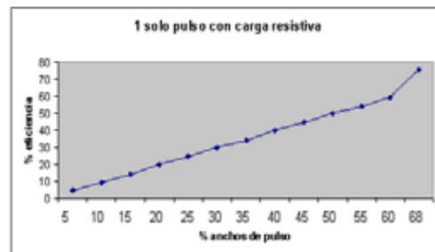
Figura 4.- Eficiencia con control PWM, un solo pulso.
