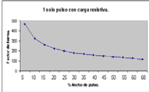
Figura 5.- Factor de forma con control PWM, un solo pulso.
