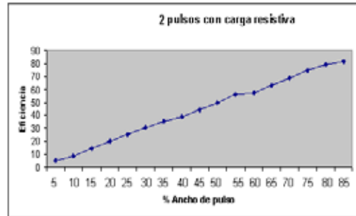
Figura 8.- Eficiencia con control PWM, dos pulsos.
