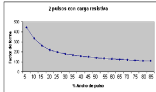
Figura 9.- Factor de forma con control PWM, dos pulsos.
