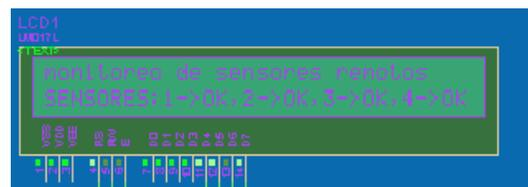
Figura 6. Mensaje al momento de revisar los sensores remotos de efecto hall.
