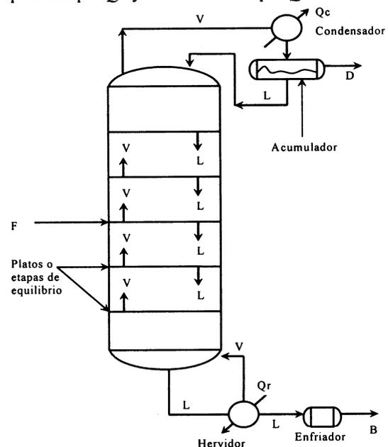
Figura 1. Esquema de una columna de destilación convencional.
