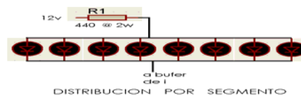
Figura 1. Composición de un segmento a partir de ocho diodos emisores de luz.
