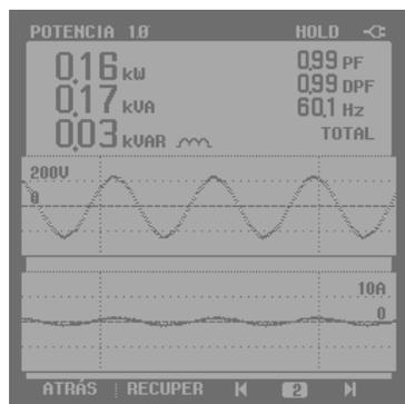
*Gráfica 16. Potencia en la entrada de la balastra operando a tensión reducida*
