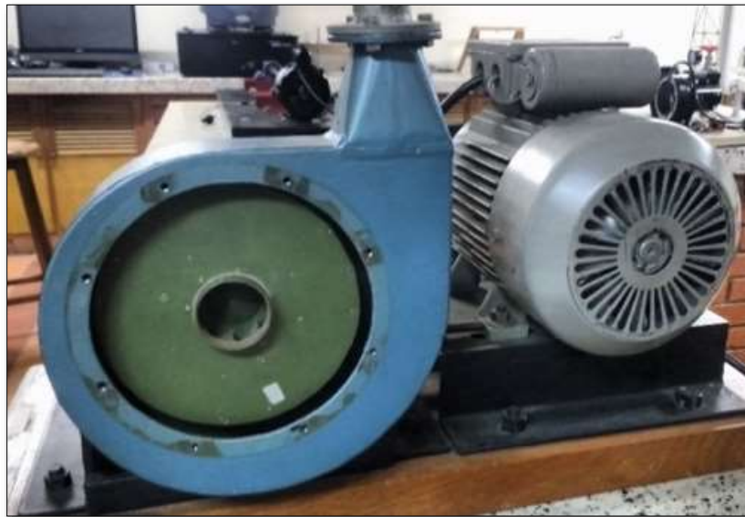
Figura 20. Ubicación de marcas en el rotor del ventilador centrífugo para la adición de masas de balanceo.
