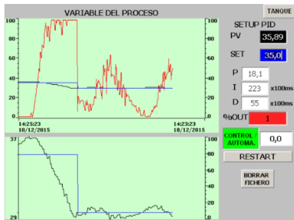
Figura 18. Salida en interfaz del proceso para un controlador proporcional-integral-derivativo. Fuente. Elaboración propia.
