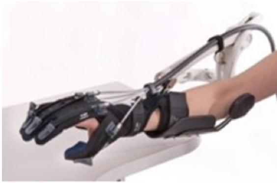
Fig. 2: guante robótico Gloreha de AEMEDI.
