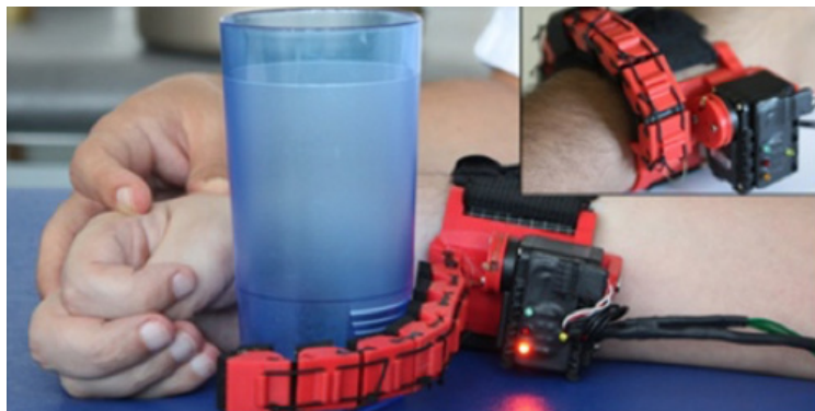
Fig. 4: Robotic sixth Finger, extra-dedo robótico de SIRSLab.
