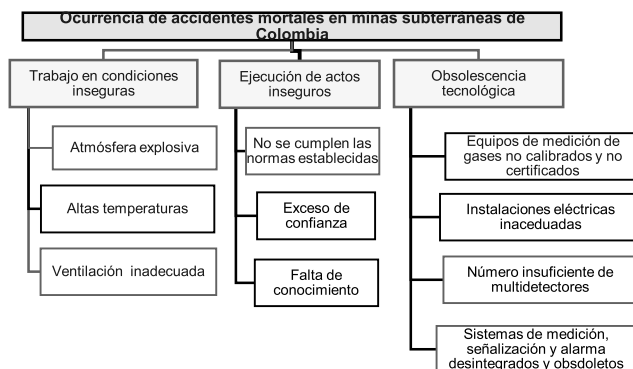
Figura 2. Análisis causal de accidente mortal minas subterráneas de carbón: explosión.
