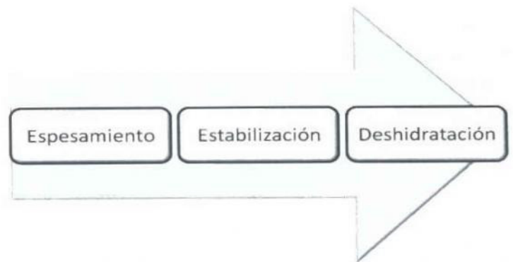
Figura 2. Etapas del tratamiento de lodos
