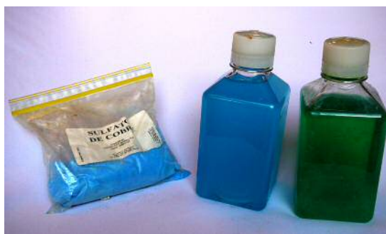
Figura 6. Sulfato de cobre, se disuelve hasta obtener un color celeste intenso (ca. 15%) y se agrega sal hasta obtener un color verde esmeralda, que corresponde al mordente sulfato salino.
