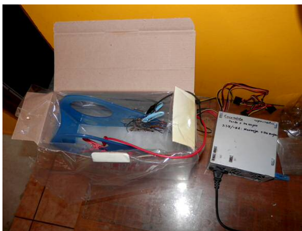
Figura 5. Sistema de grabado electrolítico. La bandeja es una caja de cartón recubierta internamente por una bolsa plástica. El positivo se conecta a la placa de grabado (cable rojo) y el negativo (cable negro) a una maraña de cables de cobre. El electrolito es sal al 25%.
