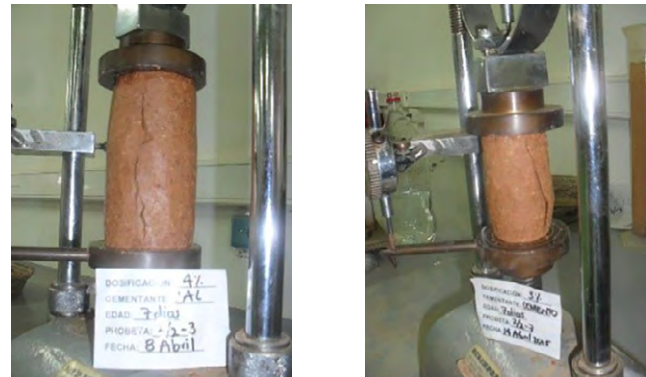
Figura 4. Ensayo de compresión confinada para probetas de mezcla suelo-cal (izq.) y suelo-cemento (der.)
