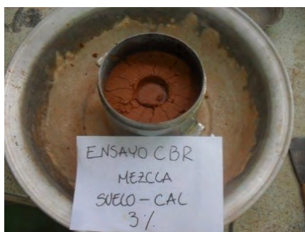
Figura 1. Probeta de mezcla suelo-cal después del ensayo CBR.
