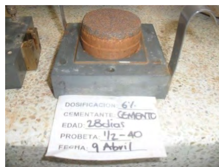
Figura 2. Falla en el ensayo de corte directo de la muestra de mezcla suelo-cal para un curado de 28 días.
