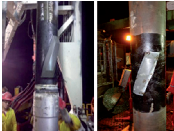
Figura 4. Centralizadores Protech CRB instalados en el Pozo C8.
