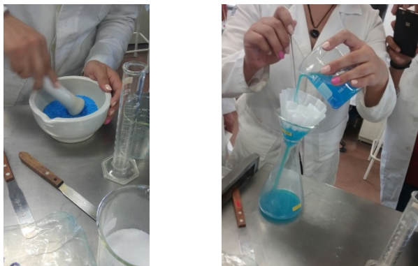
FIGURA 1. Pulverizado del vitriolo azul (izq.) y posterior filtrado de la dilución (der.)
