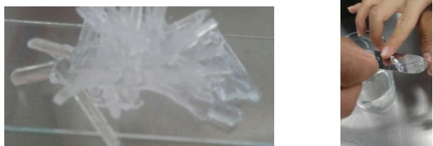
FIGURA 5. Semillas de cristales de Sal de Epsom (izq.) y semilla seleccionada para posterior crecimiento (der.), se observa su correspondiente red de Bravis hexagonal.
