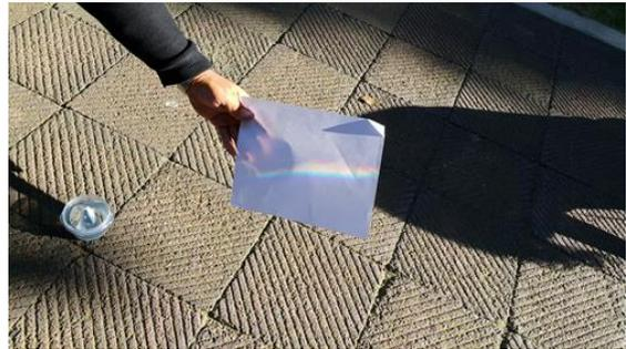
**FIGURA 8.** Prisma de agua y espectro solar obtenido sobre una hoja blanca.
