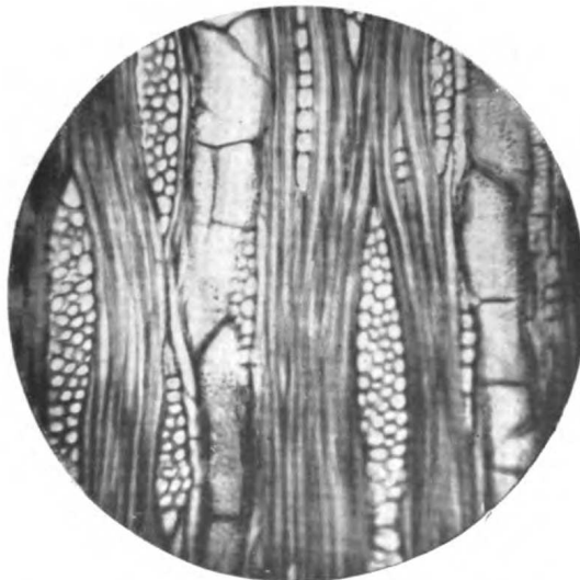
Fig. 4. — Sección tangencial de madera de quebracho ablandada con agua en ebullición, en la que pueden verse dos vasos con tabiques, tilios y puntuaciones; los radios medulares simples y multiseriados, fibras tabicadas y células parenquimáticas perivasales, contiguas al vaso de la izquierda.
