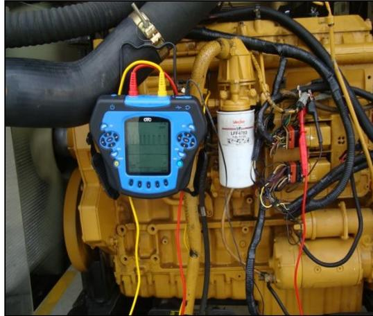
Figura 2: Toma de datos de sensores y actuadores en el motor CAT 3126 con sistema de inyección HEUI.
