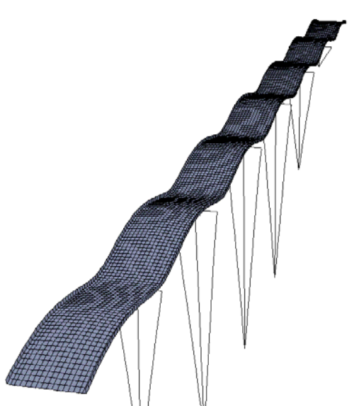
Figura 3.8 Deformación del tablero. Fuente: Elaborado por el autor
